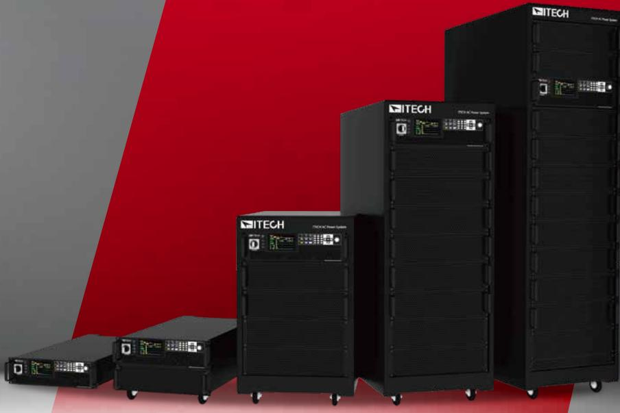
IT8200系列是一款回馈式的可编程交/直流电子负载,采用碳化硅(SiC)技术,高效的回馈能力可以将电能无污染的回馈电网,节省用电和散热成本的同时也符合节能环保的需求。AC模式下同时支持整流和非整流,提供了CC/CR/CP/CS/CC+CR/CE等多种操作模式,其中CE模式可以模拟单相整流RLC和并联RLC等多种电路拓扑。IT8200可以广泛应用于电动车对电网测试(V2G)、电动车充电站(EVSE)、逆变器(Inverter)、储能变流器(PCS)、不断电系统(UPS)等多个领域。
