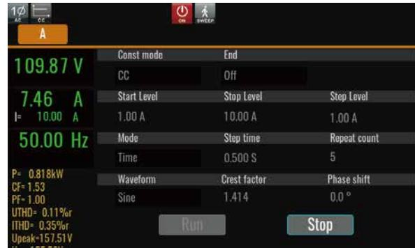
在NORMAL/LIST/SWEEP三种功能模式下均可以叠加Surge&Sag，用触发或者周期去控制凸陷波的跌落，设置的跌落的起始角度，支持波形平滑、对称和非对称波形操作。可以快速创建波形以复制波形失真或瞬态事件，例如尖峰、丢失或任何其他可以绘制为单个周期的异常。
