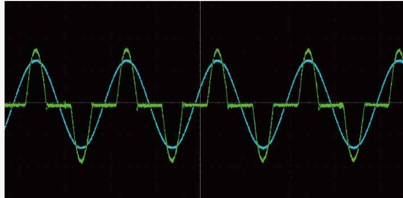
IT8200系列在交流模式下可以开启Rectified整流功能，使负载工作在第一和第三象限，电压和电流始终同向。此时，用户可以选择波形完整性，包括全波，正半波，负半波。
